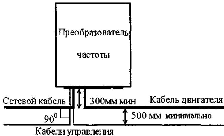
Рис. 15 Схема монтажа преобразователя частоты
