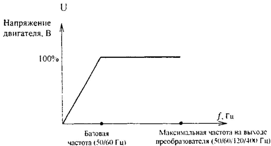
Рис. 4 Зависимость напряжения двигателя от базовой частоты
