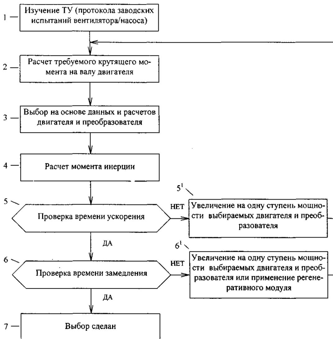
Рис. 2 Схема алгоритма выбора преобразователя частоты и двигателя для вентилятора/насоса
