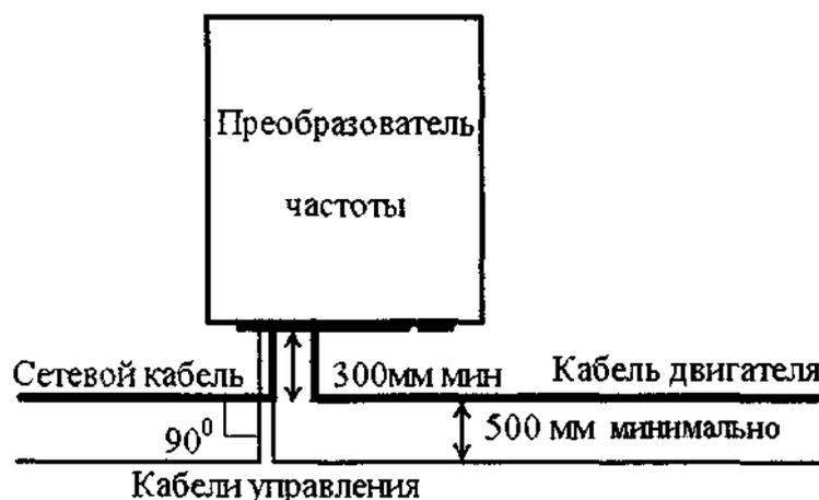
Рис. 15 Схема монтажа преобразователя частоты
