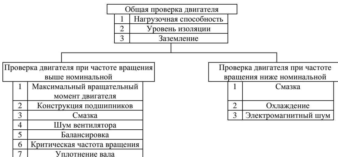
Рис. 3 Схема проверок двигателя при управлении от преобразователя частоты
