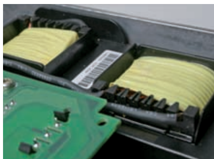
Дроссели постоянного тока уменьшают гармонические искажения и защищают привод. Так же встраиваются и RFI фильтры (соответствие нормам EN55011 A2, A1 или B).
