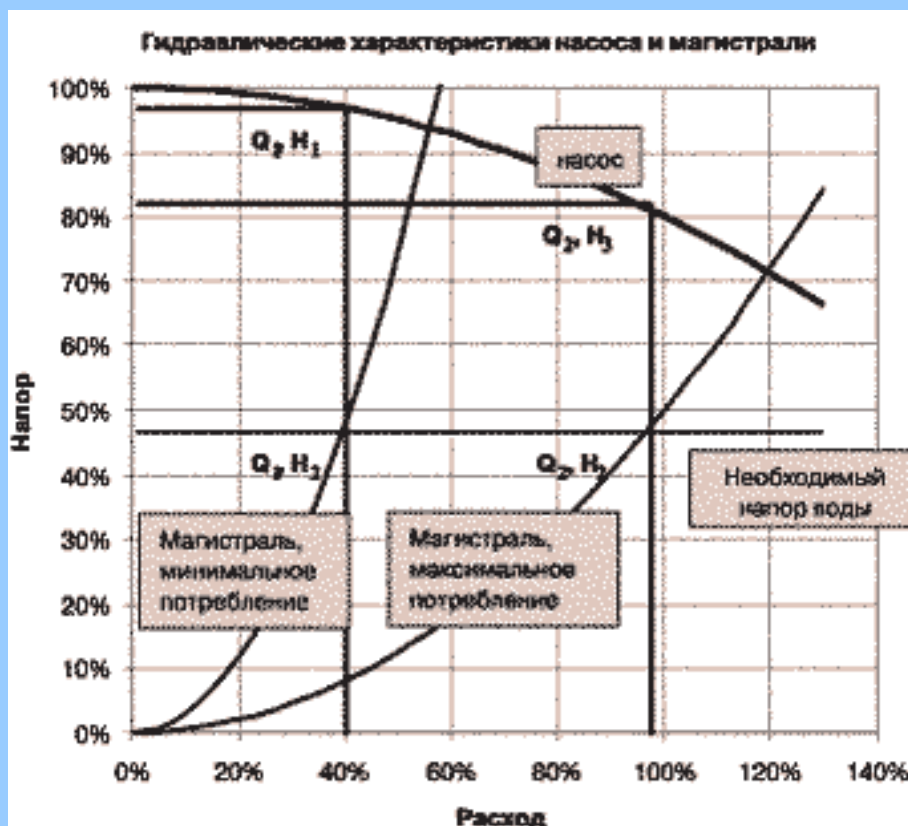
Рисунок 2. Гидравлические характеристики насоса и магистрали Общие затраты энергии соответственно равны Q_2 H_3 и Q_1 H_1 .
